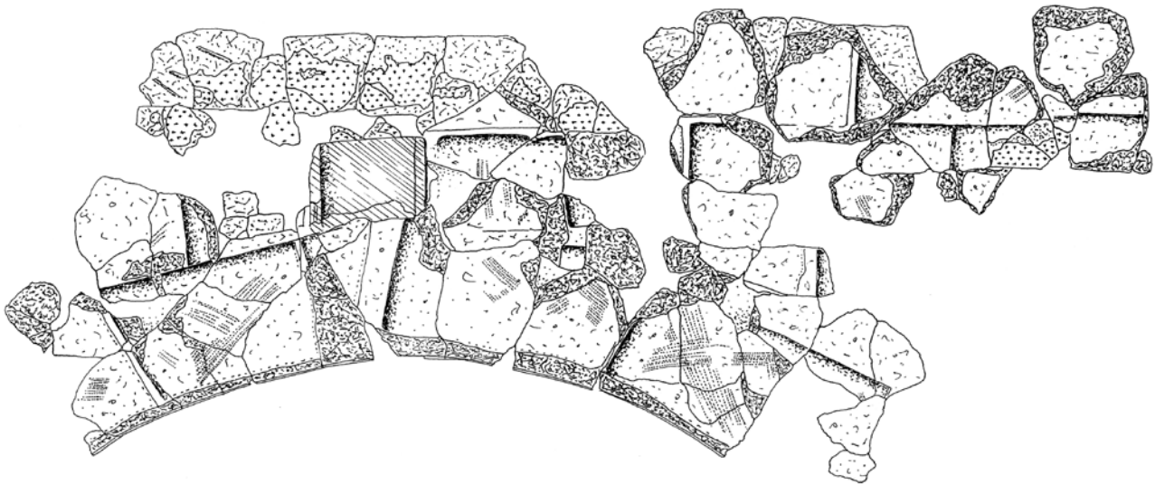
Fig. 7. Empreintes de tubuli au revers d'une arcade (dessin J. Boislève, CEPMR).
