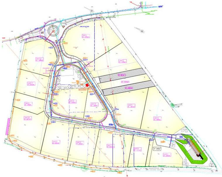
Figure 2. Scénario 1 : réseau pluvial séparatif et bassin d'infiltration aval (source : document SEDic ayant servi à l'établissement du scénario 1).
