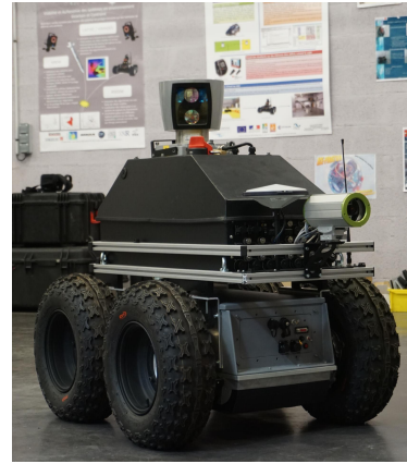
(b) Dispositif placé sur petit robot- véhicule Segway RMP440
