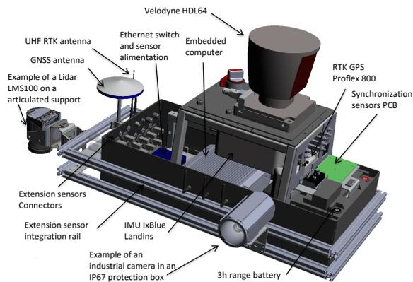
(a) Instruments contenus dans le coffre de toit de référence. La localisation est assurée par la fusion d'IMU à fog, d'un GPS RTK et d'un odomètre. Un ensemble de capteurs peut être ajouté sur les rails d'extension en fonction des expérimentations.
