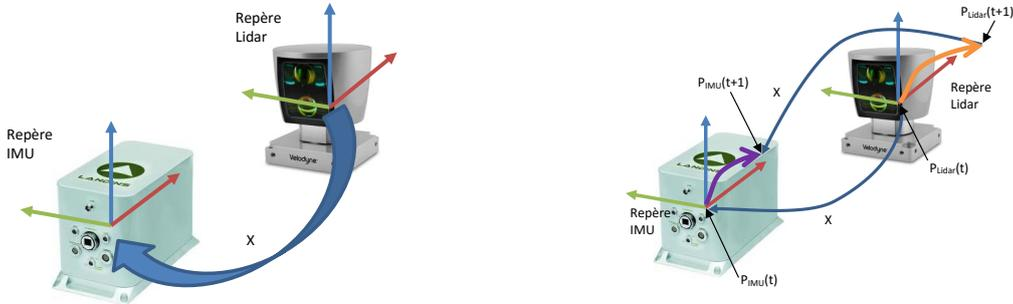
(a) Le calibrage extrinsèque consiste à déterminer la transformation  $X$ , permettant d'exprimer les points Lidar dans le repère de la centrale inertielle. Connaître  $X$  est nécessaire pour reprojeter des impacts Lidar géoréférencés.
