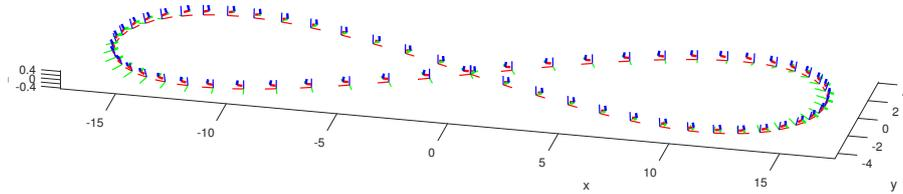
FIGURE 8 – Trajectoire en forme de huit générée en simulation. Grands trièdres : positions de la centrale inertielle, petits trièdres : positions Lidar. La simulation tient compte de la courbure de la trajectoire afin de générer des variations d'angle de roulis.
