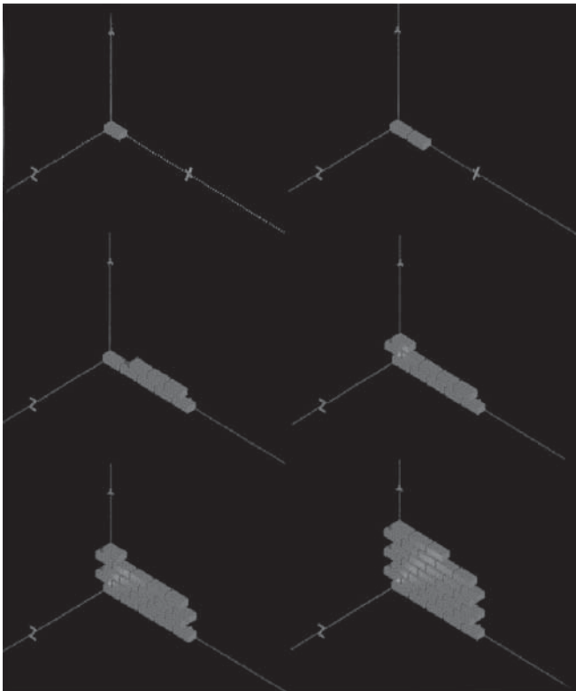
Fig. 3 : Exemple de représentation du savoir-faire : méthodes de construction des murs des cabanes monocellulaires.
