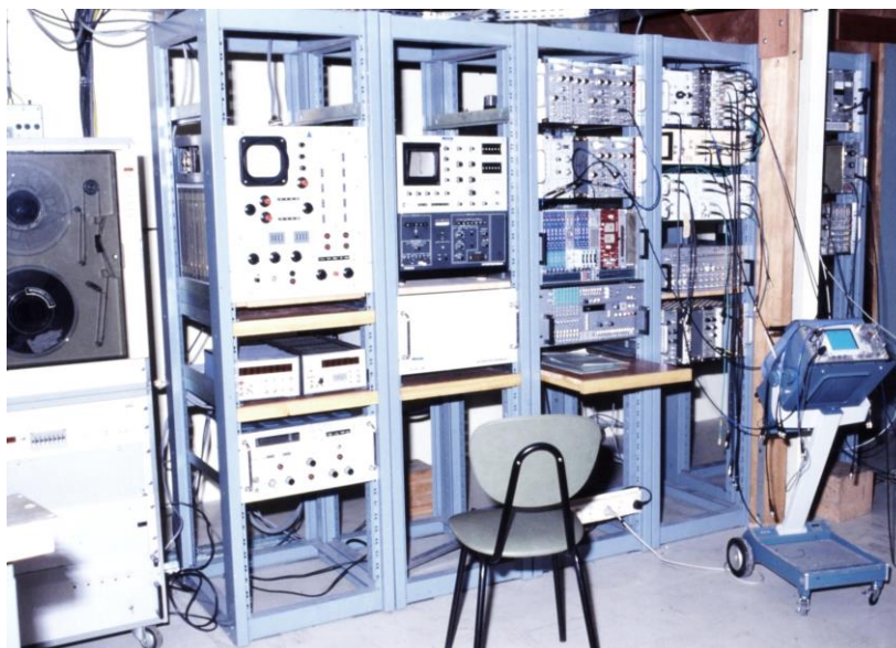
Photo 35 1978 Annexe pour l'acquisition des données avant le montage de l'expérience. De gauche à droite : l'ordinateur PDP, un bloc mémoire et l'électronique pour l'alimentation des détecteurs et l'amplification des signaux qu'ils délivrent
