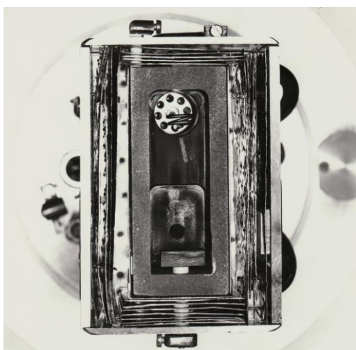
Photo 5 Chambre d'ionisation de la source d'ions entourée de réflecteurs
