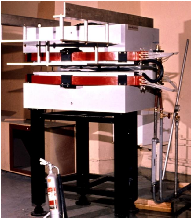
Photo 7 1973 Aimant d'analyse et sa chambre à vide
