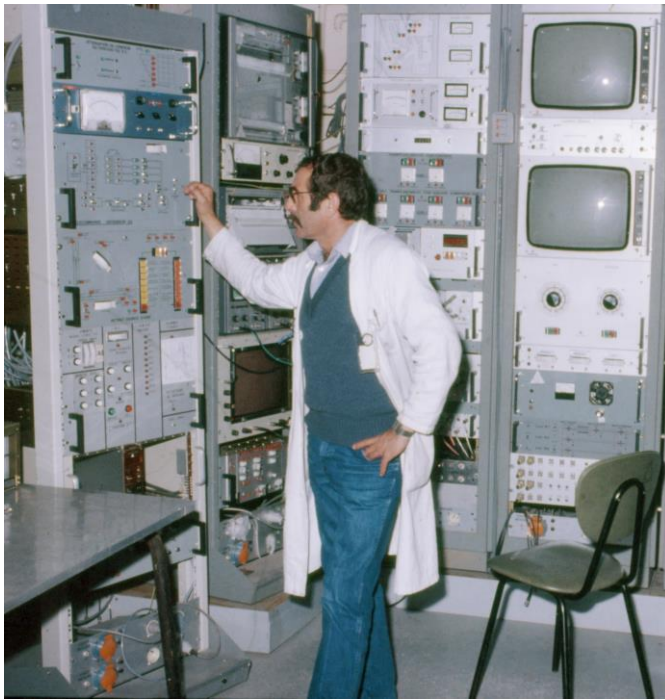
Photo 15 1981 A. Ferro devant la télécommande du mécanisme de manipulation automatique de source
