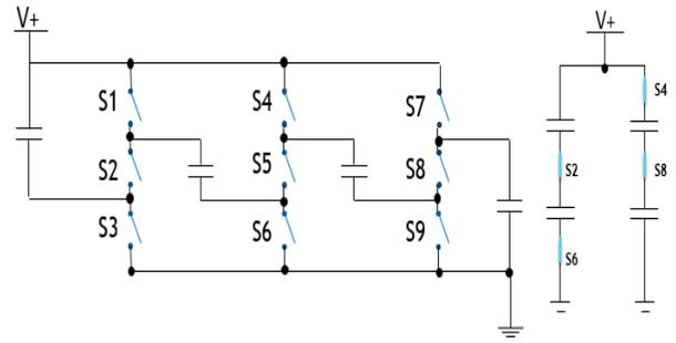
Figure 2: a) A droite, l'architecture de la première structure adaptative [5]. b) A gauche, La configuration « SP » de cette architecture.
