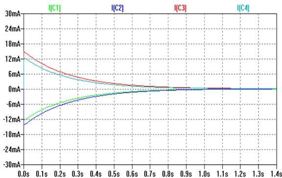
Figure 9: Le pic de courant dans les supercondensateurs à la 2<sup>ème</sup> commutation, pour la deuxième structure adaptative [6]
