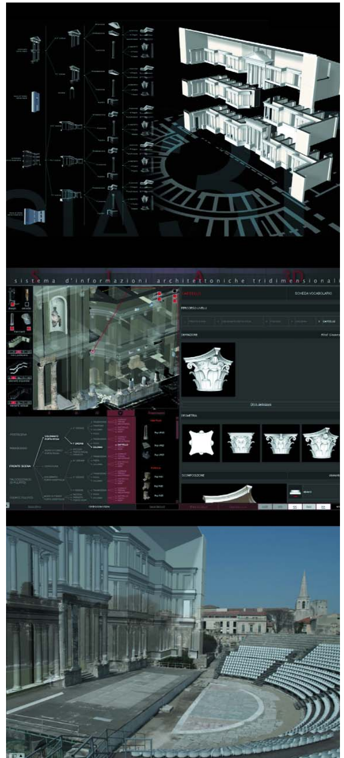
Fig. 6 : S.I.A.3D : Système d'informations architecturales 3D. Application sur l'étude du théâtre romain d'Arles. De haut en bas : Le modèle de description de l'objet ; l'interface du système d'information 3D ; une simulation de réalité augmentée.
