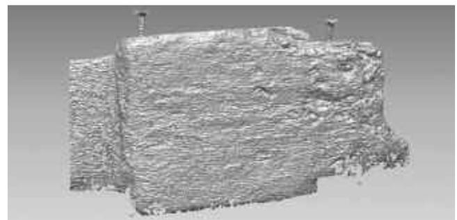
Fig. 3 : Numérisation des bois à puissance laser élevée.
