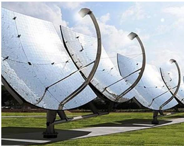
*Tracker avec concentration optique à double courbure pour le solaire thermodynamique avec moteur Stirling (source Zenithsolar)*
