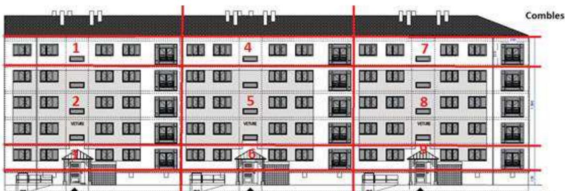
Figure 62 : répartition des zones thermiques pour les modèles 2 et 3
