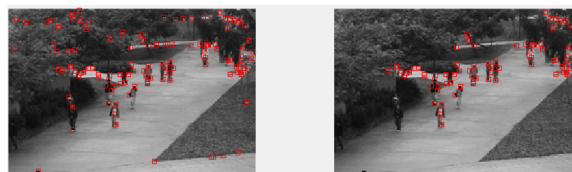
FIGURE 3 – Résultat de sélection de points d'intérêt par utilisation de la probabilité de saillance. A gauche la détection initiale et à droite détection après filtrage
