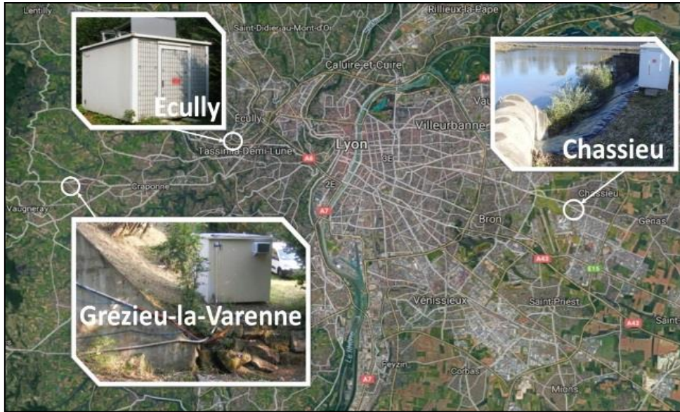
Figure 1. Localisation des sites OTHU sur réseau d'assainissement équipés pour le suivi en continu.
