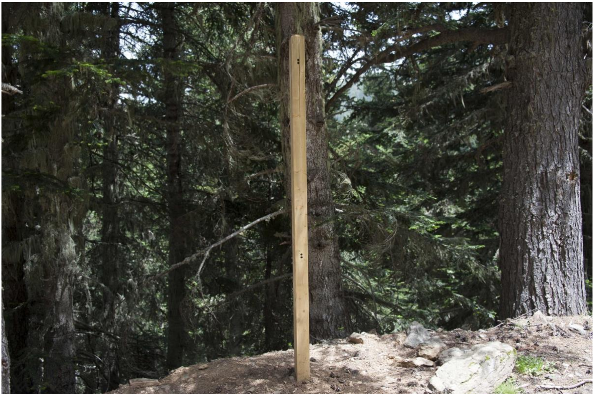
Ecocompteur différentiel 4 flux (piétons, vélos, chevaux, véhicules) connecté par GSM dans le Grand site du Canigó. Cliché Vlès, juillet 2016.
