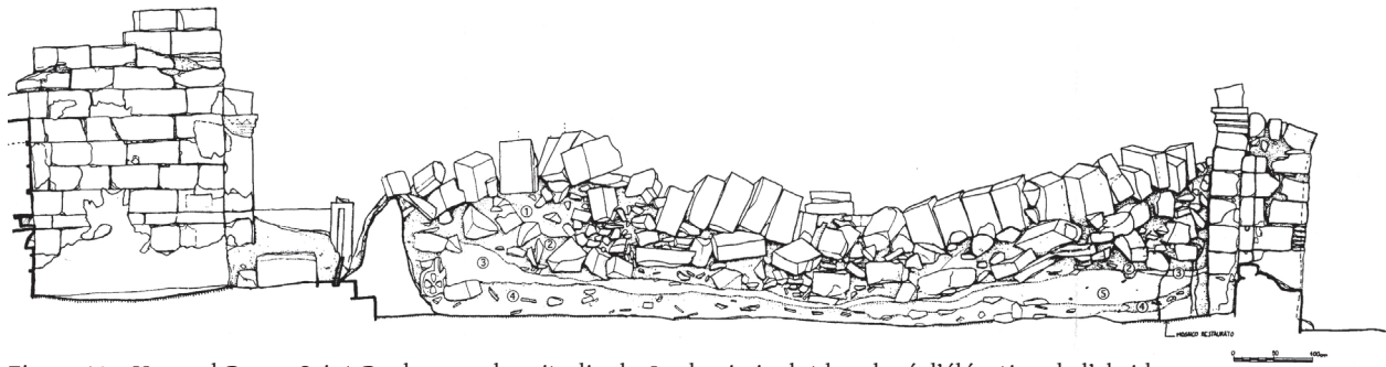
Figure 19 – Umm al-Rasas, Saint-Paul, coupe longitudinale. Le dessin inclut le relevé d'élévation de l'abside, les arcades méridionales de la nef et les niveaux sous-jacents dont la stratigraphie est relevée. [Relevé et dessin B. Steri 1996-1997, dans Piccirillo 1997, sezione 1, face p. 385]
