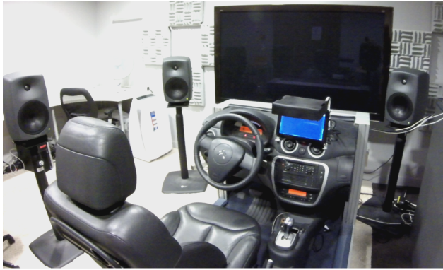
FIGURE 6.3 – Vue alternative du simulateur de conduite que nous avons utilisé pour l'expérience 5. Le capteur de geste est placé dans la boîte noire placée au-dessus de l'écran central.
