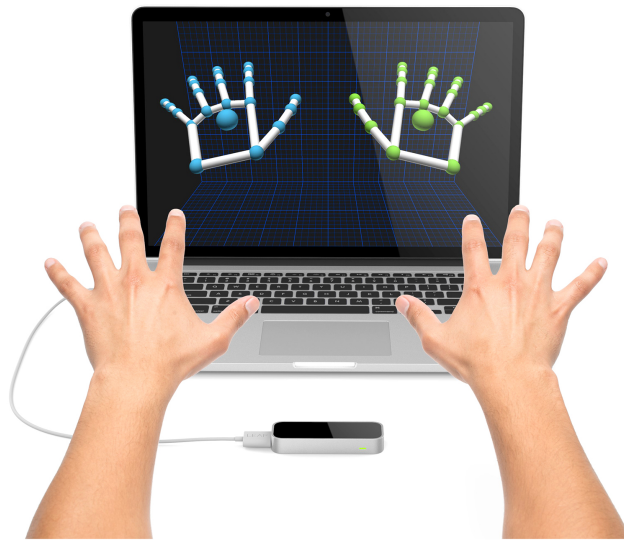
FIGURE 1.5 – Le capteur Leapmotion et ses algorithmes permettent de reconstruire schématiquement les mains de l'utilisateur.
