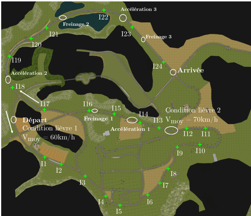
FIGURE 6.6 – Vue d'ensemble du circuit proposé. Les endroits où les instructions ont été proposées sont signalés par des croix vertes, avec la notation I_x , où x est le numéro de l'instruction.
