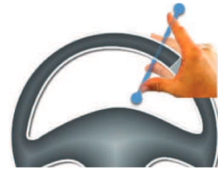
FIGURE 1.6 – Exemple de micro-geste de zoom au volant tiré de [Mahr et al. , 2011].
