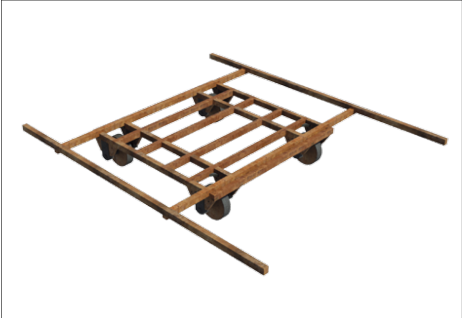
Fig. 7 – Les « antennes » sur la tortue d'Athénée
