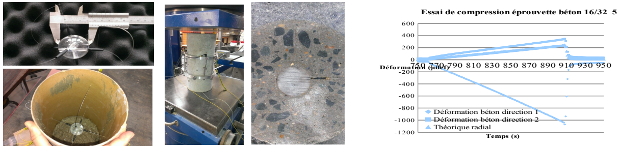
Fig. 5: Inclusion d'un capteur 3D dans une éprouvette béton.
