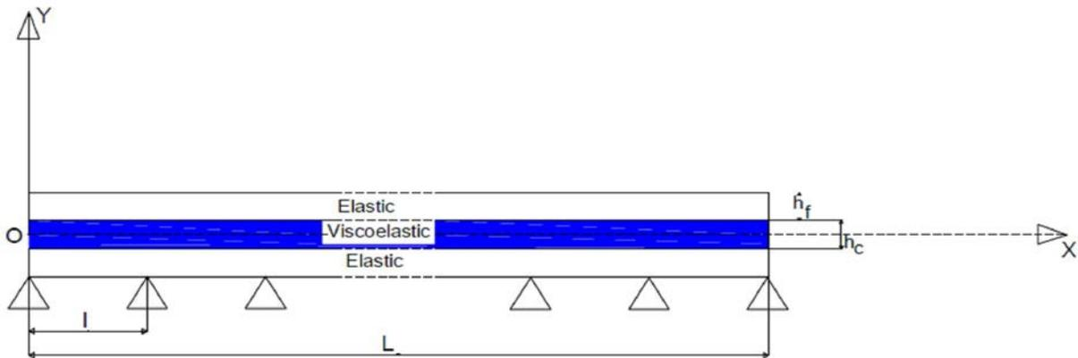
Fig. 2. Longue structure sandwich viscoélastique répétitive
