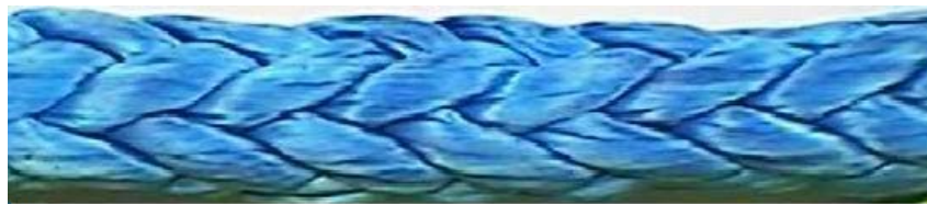
Fig. 2 – Câble réel (2 couches, chacune de 6 torons x 7 brins)
