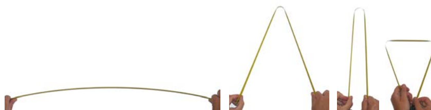
Fig. 1 – Pliage d'un mètre ruban par flexion
