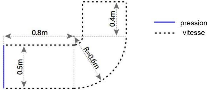
Fig. 1 – Cavité acoustique en forme de L.
