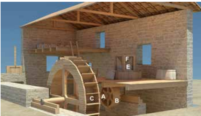
Fig. 3 – Le moulin à eau décrit par Vitruve, vue éclatée (Unicaen – Plan de Rome, France)
