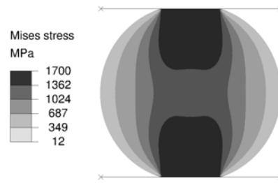
Fig. 3 – Champs de contrainte de Mises obtenus numériquement avant le point d'inflexion de la figure 2 (b) avec le modèle de VM - limite d'élasticité de 1700 MPa.
