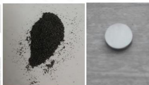
Fig. 2. Izq. Muestra en polvo. Der. Muestra sólida de aleación Ti-6Al-4V. Fuente: Autores del proyecto
