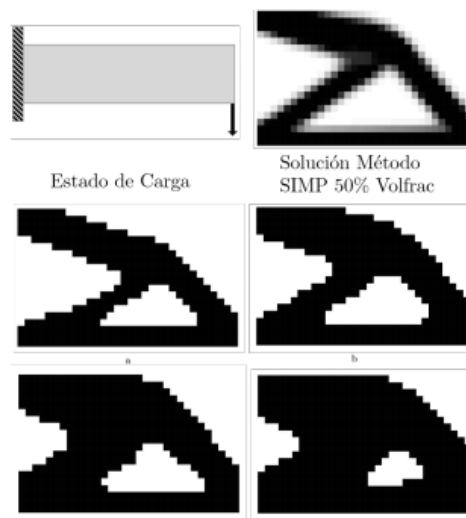
Fig. 3. Resultados de optimización topológica para viga en voladizo comparación método SIMP Y BCBTOA para diferentes porcentajes de volumen a)50% b) 60% c) 70% y d) 80% Fuente: (Leon-Medina, 2016).
