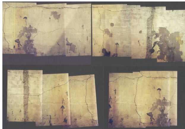
Fig. 1. Réseau de fissures développé dans un revêtement réfractaire de durée d'une poche à acier observé lors la première réfection de la couche d'usure [22]
