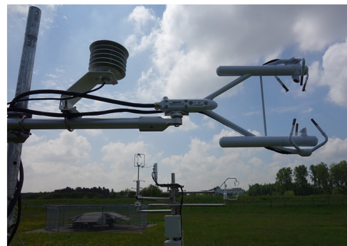
Figure 1 : Au premier plan, l'IRGASON, au second plan à droite, l'anémomètre CSAT-3 et le LI-7500.
