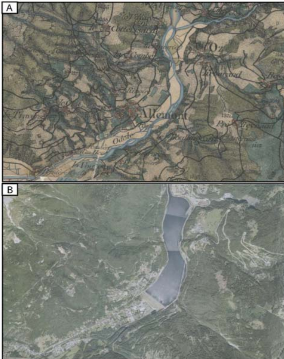
Figure 3. Evolution dans le temps de la vallée au niveau de la commune d'Allemont (Isère) (a) Carte d'état major (1820-1866), (b) Photo satellite (2005) après la construction du barrage du Vernay au début des années 1980 / Evolution with time of the Eau d'Olle valley near Allemont, Isère, French Alps, (a) military map (1820-1866), (b) satellite imagery (2005) after the construction the Vernay dam in '80.
