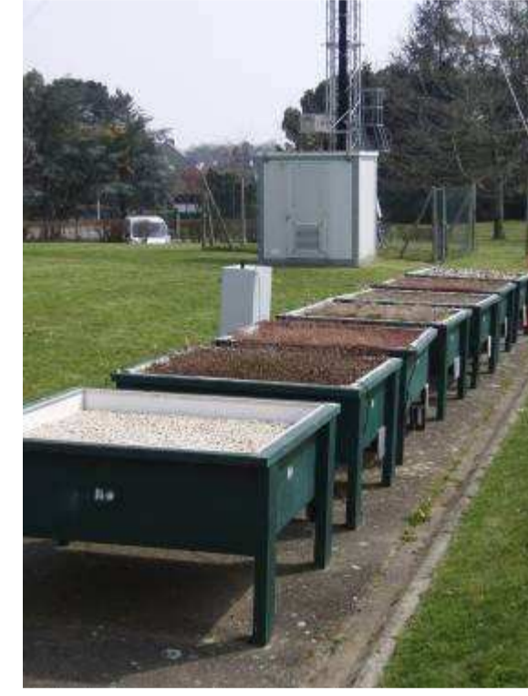
Figure 2 : Photographie des compartiments végétalisés de Nantes
