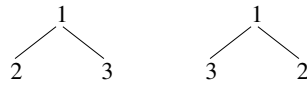
FIGURE 2.4 – Les deux tas possibles sur \{1, 2, 3\} . Sous le modèle des permutations uniformes et en construisant le tas par l’algorithme de Floyd, le premier tas est obtenu par les permutations 123, 213 et 321, le second par les permutations 132, 231 et 312 ; les deux tas sont équiprobables. Avec l’algorithme de Williams, le premier tas est obtenu par les clés entrées dans l’ordre des permutations 123 et 213, et le second tas par les permutations 132, 231, 312 et 321 ; le second tas a donc une probabilité double du premier.
