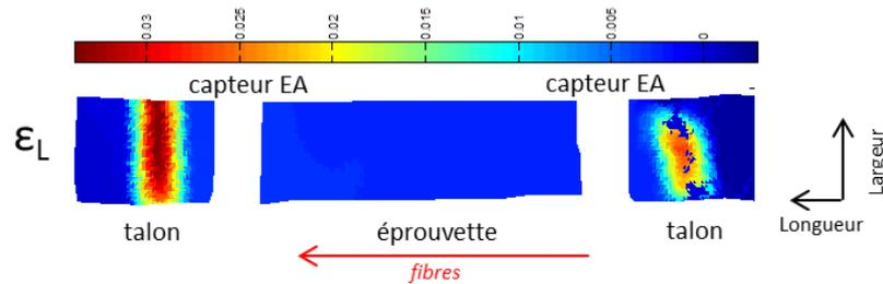
Figure 4 – Champ de déformation longitudinale sur l'éprouvette obtenu par CIN.
