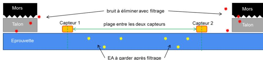
**Figure 2** – Schéma représentatif de la technique des Emissions Acoustiques ; filtrage par localisation.
