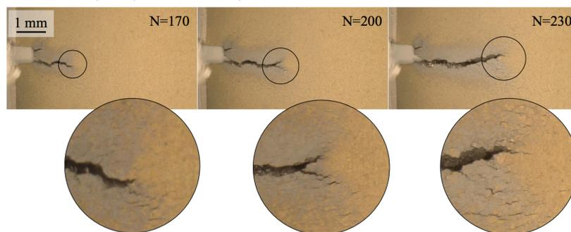
**Figure 1.** Observation de surface d'une éprouvette SENT pour un superalliage base Co Ha188 testé à  $T=900^{\circ}\text{C}$  –  $R\epsilon=0.1$  –  $\Delta\epsilon/2=0.25\%$ .  $N$  correspond au nombre de cycles, les zooms correspondent aux zones entourées pour chacune des images de surface prises à charge maximale (la largeur de l'éprouvette est de 18 mm pour une épaisseur de 4 mm).
