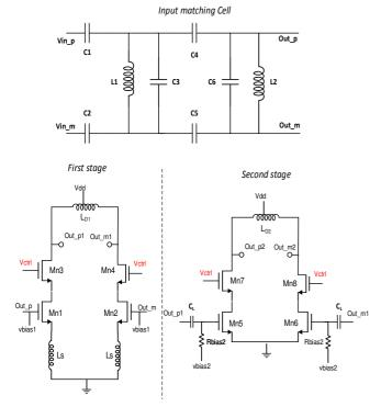
Fig. 3 LNA transistor level implementation.
