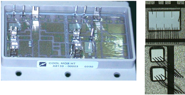
Figure 10: Module intégré de puissance prototypé pour des applications hautes températures (puce CoolMOS Si – 2 puces Diode Schottky SiC).
