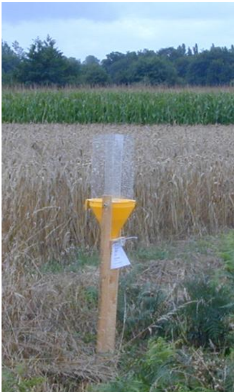
Figure 2. Piège jaune à interception utilisé dans le programme Greenveins (Cliché : S. Aviron).
