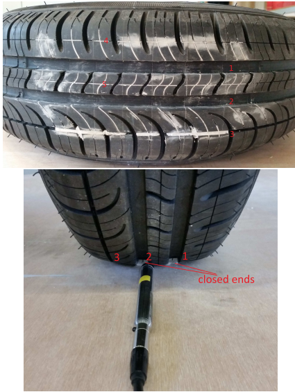
FIGURE 11 – (a) Zone de contact ; (b) Pneumatique avec un réseau fermé.
