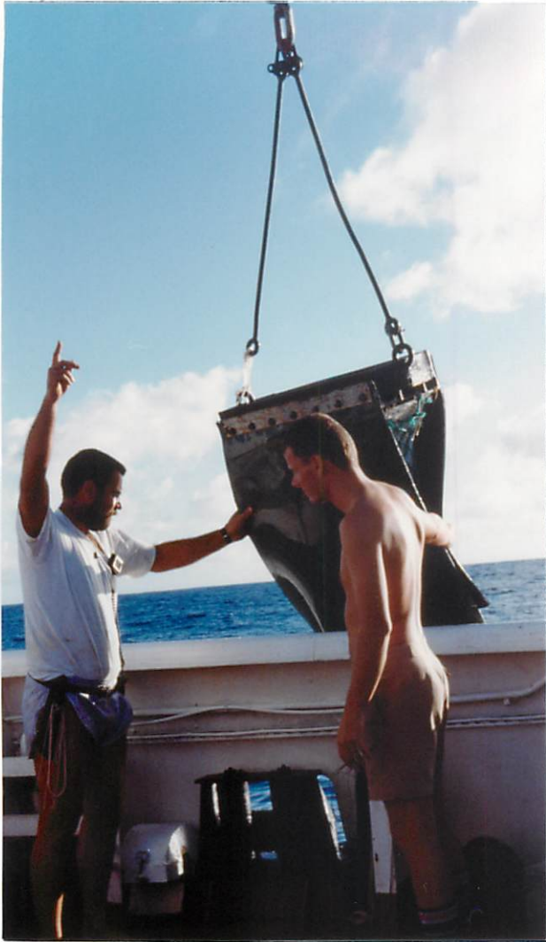
1 - Mise à l'eau d'une drague Charcot . Après les premiers essais, les deux bras en fer rond ont été remplacés par deux chaînes mieux adaptées aux fonds durs.
