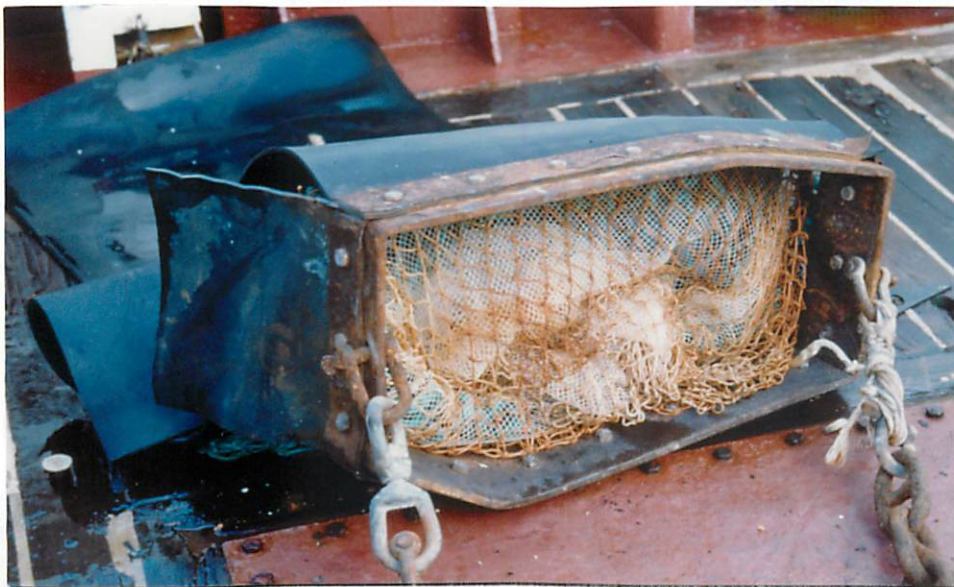
3 - Drague Charcot après une croche sur le fond. Le point de fixation à gauche est constitué par un "bout cassant", ce qui limite les risques de perte.
