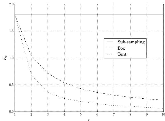
FIGURE 2 – Évolution du taux d’insertion vs facteur d’échelle.
