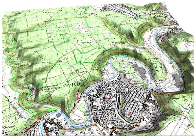
Figure 7 : MNT à partir des données SRTM drapé du scan 25 de l'IGN réalisé avec GRASS 6
