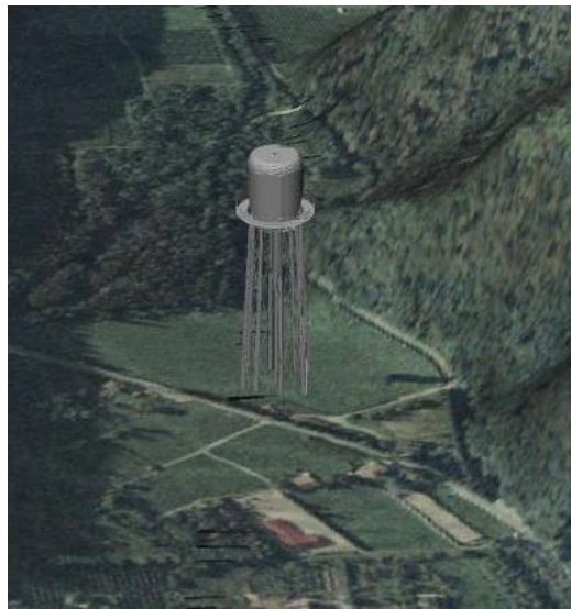
Figure 5 : Intégration d'un fichier « .dxf » dans un MNT drapé par une orthophotographie, réalisée sous Grass.fbk.eu
