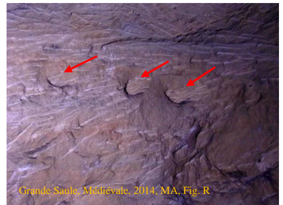
Ci-dessus, mise en place d'amorces fines pré-taillées dans la roche pour l'abattage par « Keils ».
