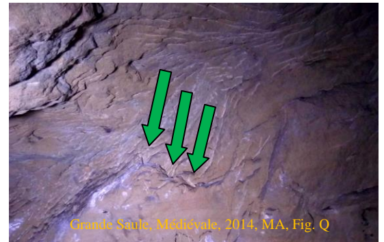
Mode d'abattage par rangées d'amorces fines
