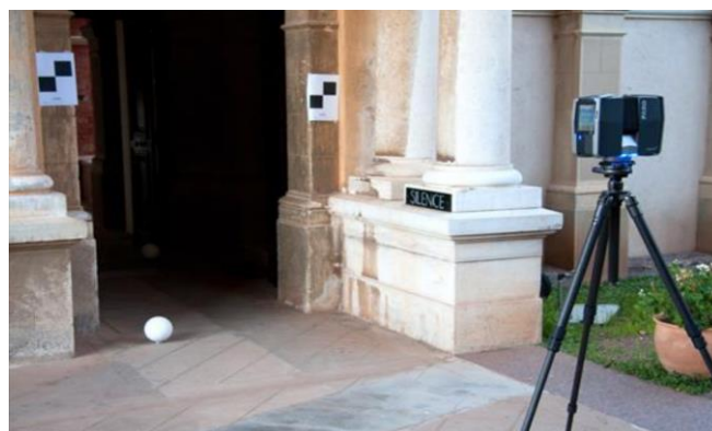
Figure 2 mise en station du scanner Faros Focus , disposition des cibles sphériques et à damiers pour assurer le relevé, la consolidation et le géoréférencement. Monastère St Honorat, Lerins (S. Sorin CEPAM)
