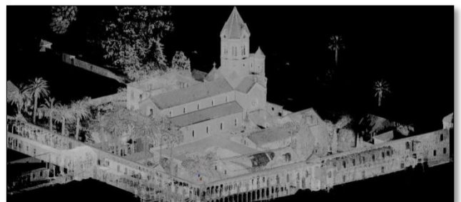
Figure 10 - Vue en réflectance du relevé par scanner laser terrestre Faros Focus 3D du groupe monastique Saint-Honorat (Iles de Lérins, Cannes). CEPAM-UMR 7264, A. Pagano, S. Sorin
