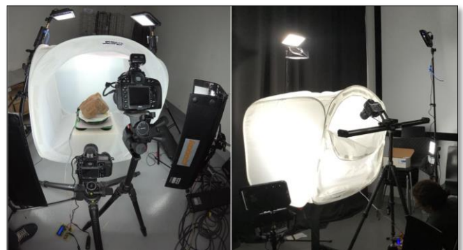
Figure 8 - Exemples d'installations de numérisation 3D par photogrammétrie avec une table tournante (MAP – UMR 3495)
