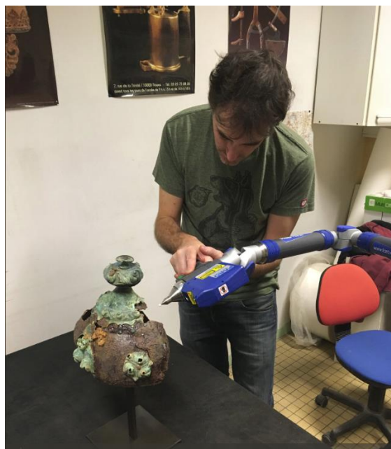
Figure 15 – Numérisation 3D d'un casque gaulois trouvé sur le site de Tintignac par lasergrammétrie avec un scanner laser Faro (Archeovision production - 2018)
