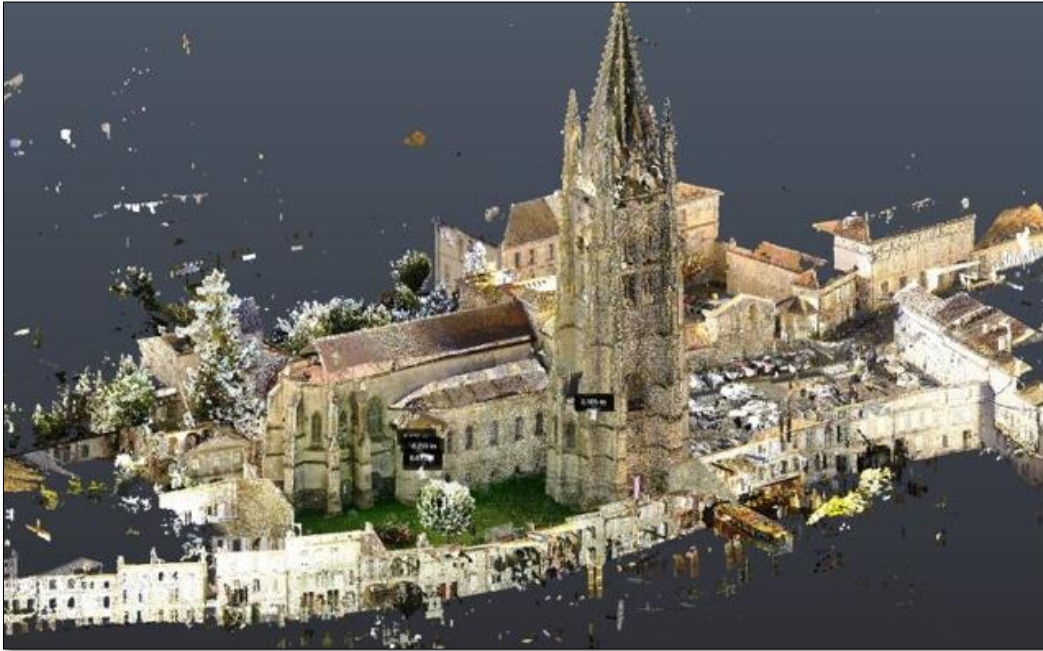
Nuage de points de la basilique Saint-Eutrope(Saintes, Charente-Maritime) obtenu par photogrammétrie (Archéotransfert/ Archéovision UMS 3657)
