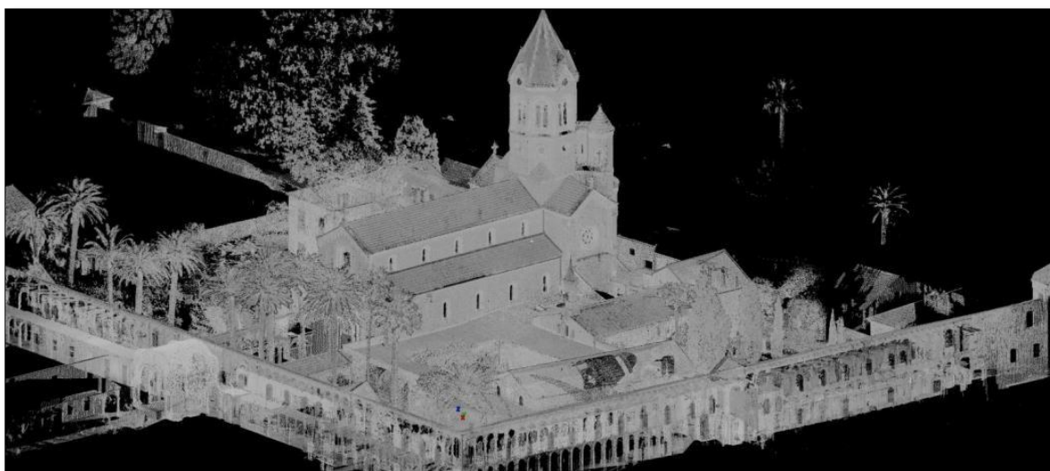
Vue en réflectance du relevé par scanner laser terrestre Faros Focus 3D du groupe monastique Saint-Honorat (îles de Lérins, Cannes). CEPAM-UMR 7264, A. Pagano, S. Sorin
