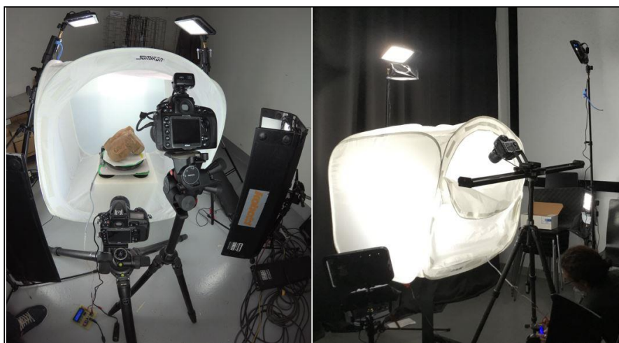
Exemples d'installations de numérisation 3D par photogrammétrie avec une table tournante (MAP – UMR 3495)
