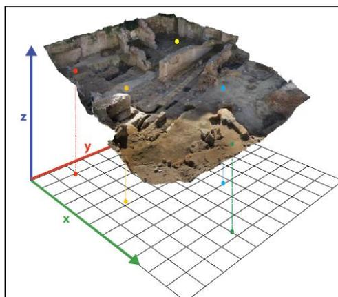
Mise à l'échelle et orientation d'un modèle obtenu par photogrammétrie.
