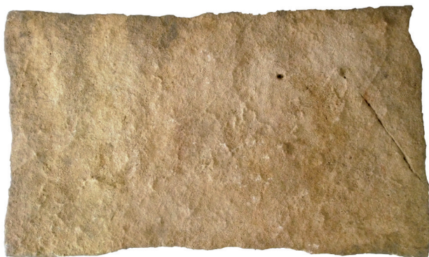
18. Sanctuaire des Sources de l'Yonne. Les matériaux de construction de la romanisation. Dalle en calcaire oolitique à entroques (cliché Fl. Delencre).
