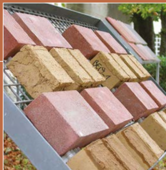
Exposition naturelle de blocs de terre imprégnés à la colle de farine
