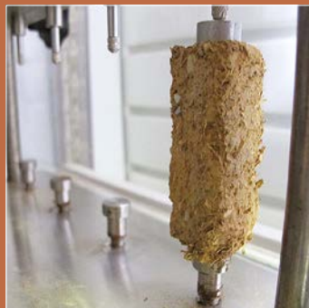
Dilatation hygrique d'un enduit
