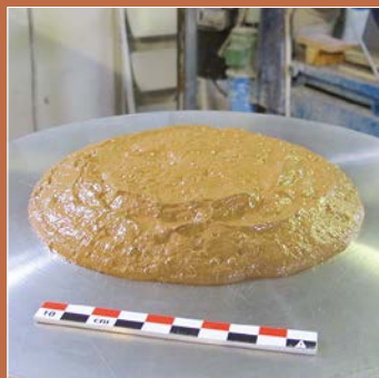
Étalement d'un enduit sur une table à choc
