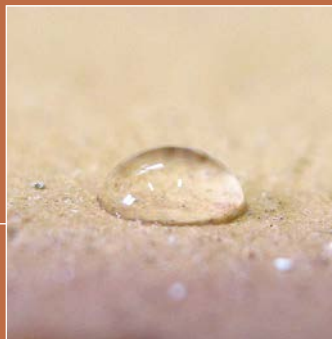
Pénétration et angle de contact d'une goutte d'eau sur une surface imprégnée
