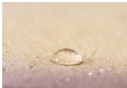
Microgoutte de 10\mu\text{L} déposée à la surface d'un bloc de terre imprégné de colle de farine
